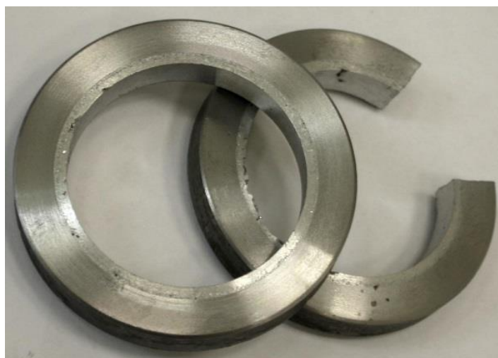
Рисунок 1. Образец с наплавленным покрытием из сплава АК12
